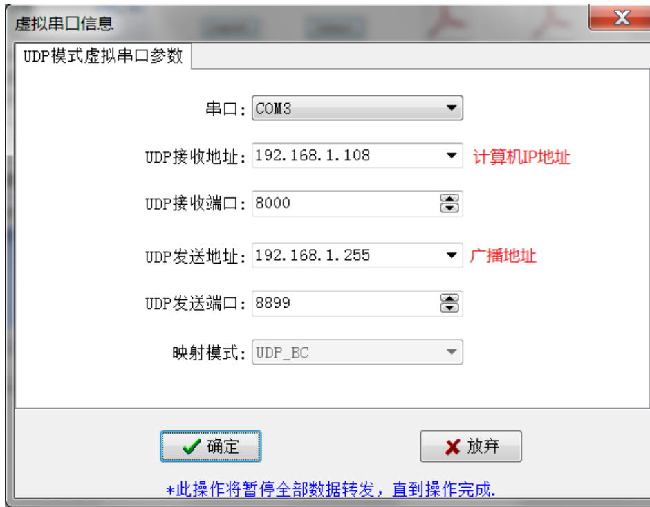
图5.1-12 虚拟串口软件作为UDP广播时的设置
