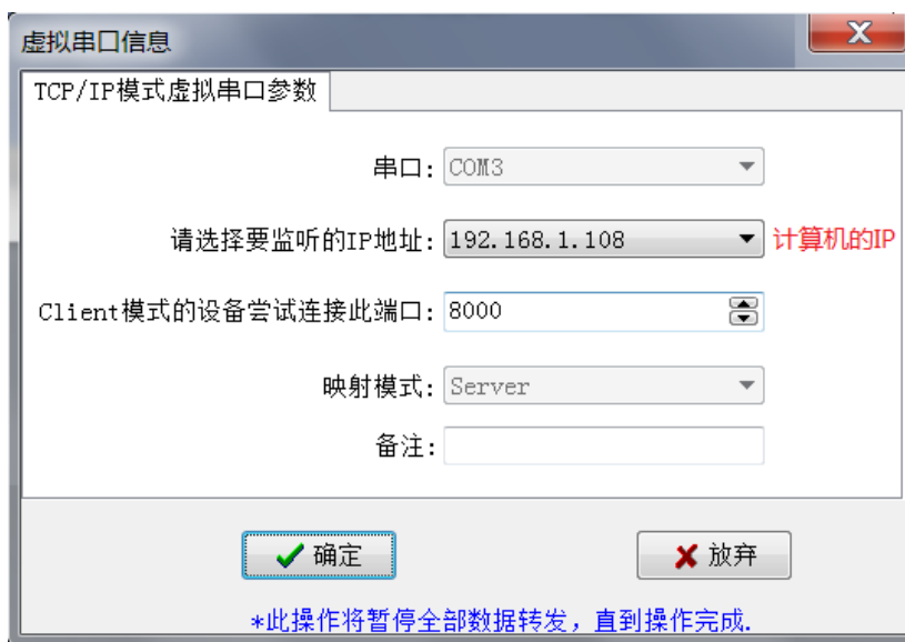
图5.1-8 虚拟串口软件作为TCP Server时的设置
