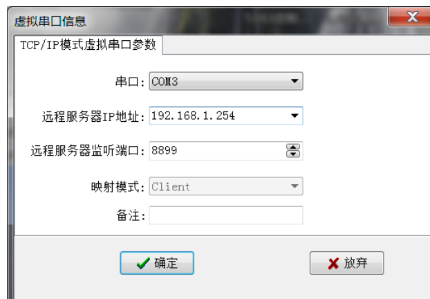
图5.1-6 虚拟串口软件作为TCP Client时的设置
