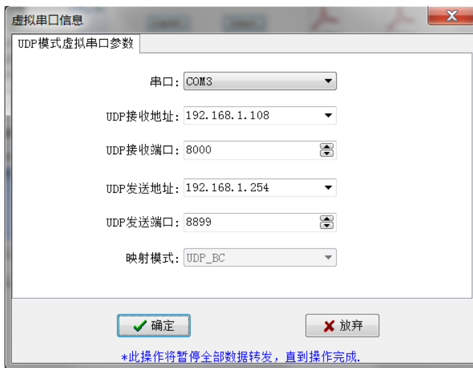
图5.1-10 虚拟串口软件作为UDP时的设置
