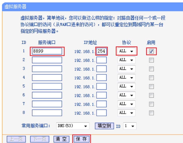
图5.4-3 路由器1的端口映射设置
